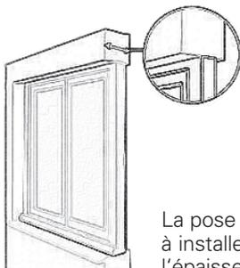
La pose en tunnel consiste à installer la fenêtre dans l'épaisseur du mur.
